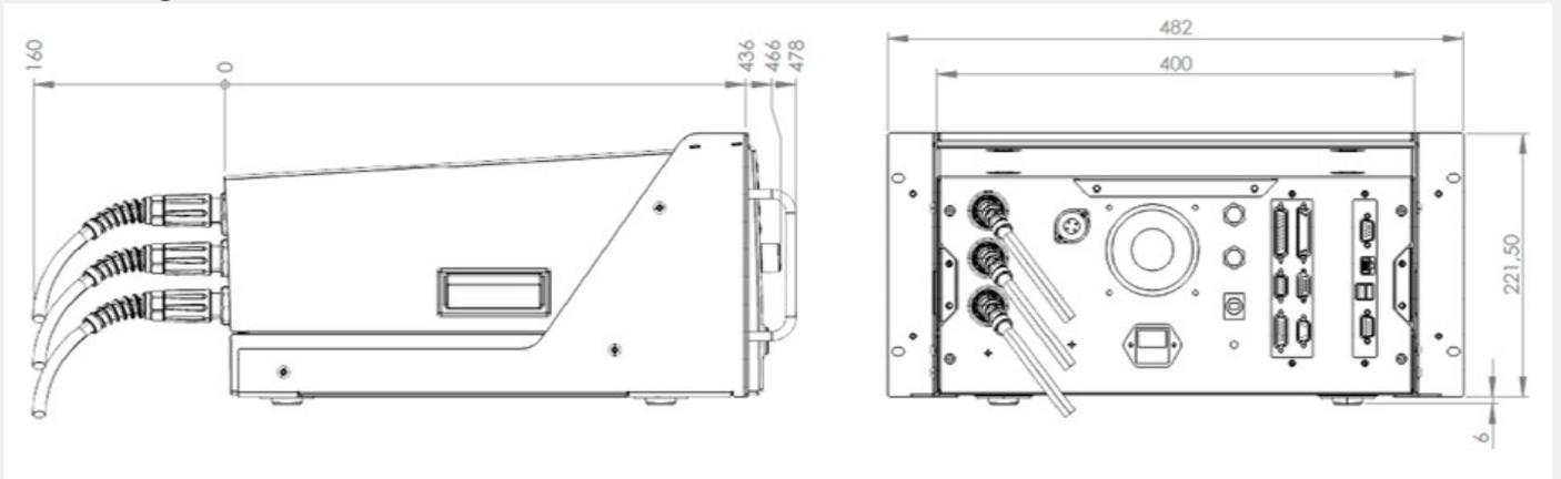
Abmessungen Gehäuse mit Einbausatz 19 Zoll und Winkelsteckern:
