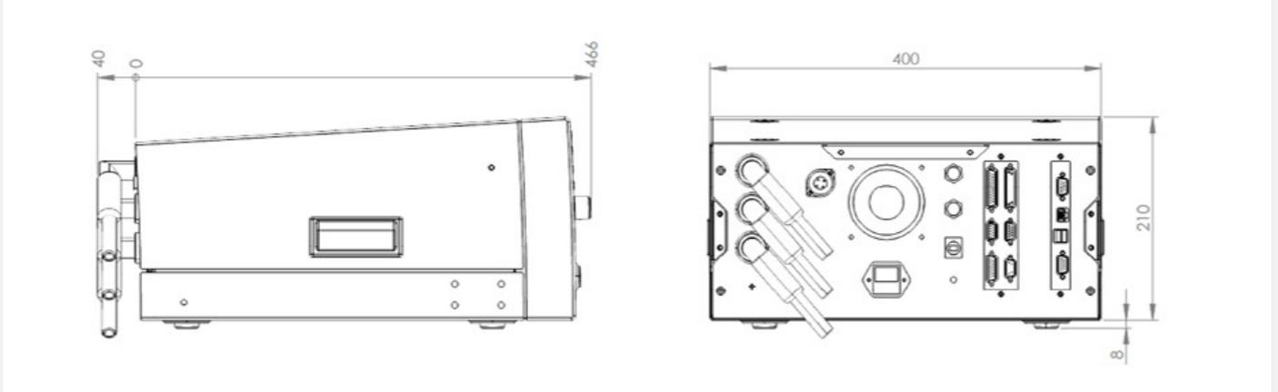
Abmessungen Gehäuse mit Einbausatz 19 Zoll:
